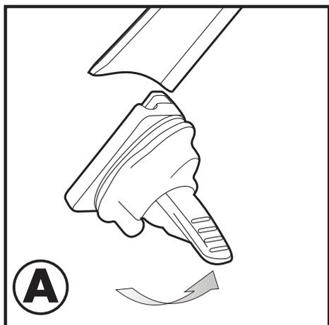
**I** Portare la leva di bloccaggio in posizione orizzontale come mostrato in Fig. A; Infilare lo schermo, utilizzando le apposite guide, come mostrato nelle Fig. B e C.
